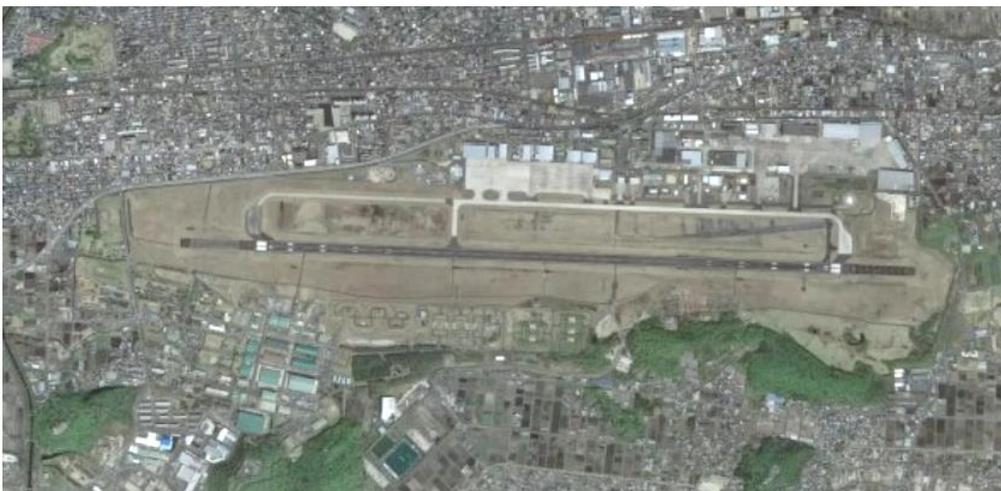
航空自衛隊岐阜基地の航空写真(ネットから)。滑走路の長さは2700m・幅45m。
